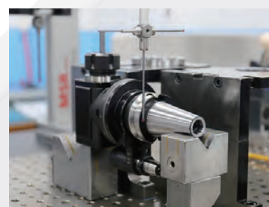
偏擺度: \leq 20\mu\text{m} 傾斜度: \pm 8\mu\text{m}
