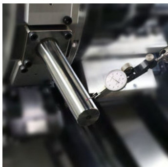
千分錶量測X軸平行度
