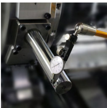
千分錶量測X軸垂直度
