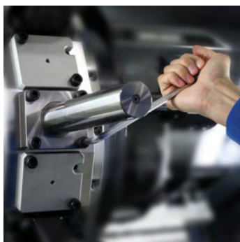
使用L型扳手鬆開 BMT檢測棒四顆螺絲
