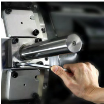
BMT標準棒裝入刀塔， 使用L型扳手鎖固四顆螺絲
