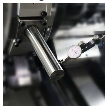
千分錶量測X軸平行度
