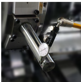
千分錶量測X軸垂直度
