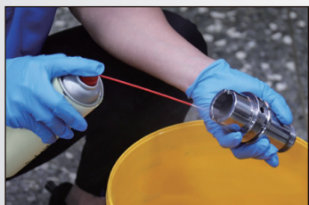
1. 使用防鏽油做防鏽處理，並戴上手套避免手的水氣或髒汙再次接觸
