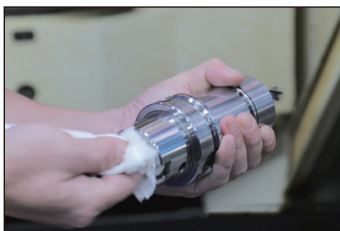
2. 使用擦拭紙將刀桿表面的髒污或切削液擦拭乾淨
