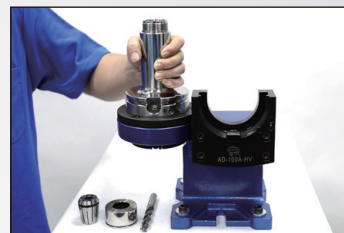
3. 將刀桿置入鎖刀座固定
