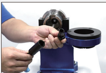
2. 使用給水管板手鎖固給水管於刀桿內
