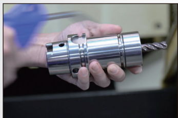
1. 使用風槍清除刀桿表面上的鐵屑以及髒(油)汙
