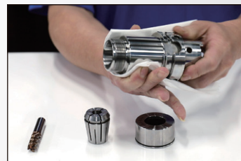
6. 使用擦拭紙擦拭刀桿、螺帽以及筒夾，將髒污或切削液擦拭乾淨
