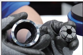
4. 將螺帽和筒夾拆下一併清潔
