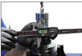
5. 置入刀具後，使用游標卡尺測量至所需刀具長度
