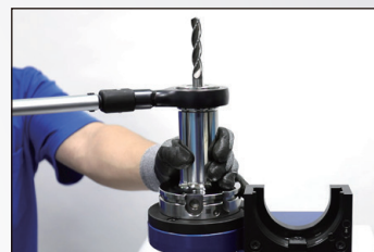
6. 使用扭力板手以順時針方向平均使力鎖緊螺帽
