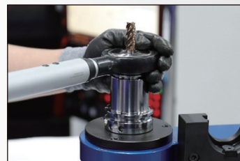
3. 將刀桿置入鎖刀座固定，使用扭力板手以逆時針方向鬆開螺帽
