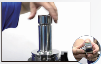
4. 將筒夾置入PRO-E螺帽，裝於刀桿上
