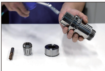
5. 使用風槍清潔刀桿、螺帽、筒夾的鐵屑以及髒(油)汙，避免凹槽或內孔殘留鐵屑
