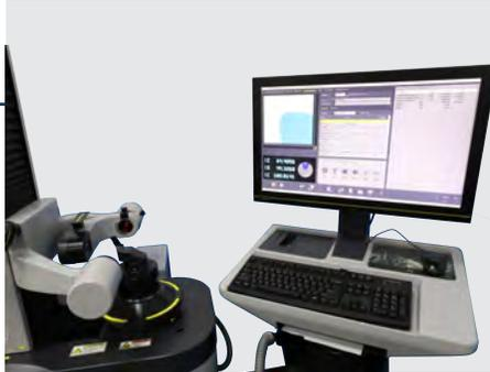
1. 刀具放置到刀具設定儀，刀具設定儀輸入刀具初始設定值
