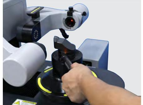
3. 刀具設定儀辨識刀具後數據值寫入晶片
