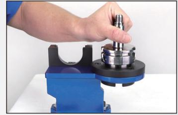
3. 將刀桿置入鎖刀座固定
