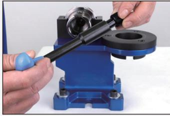
2. 使用給水管扳手鎖固給水管於刀桿內
