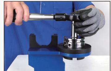
3. 將刀桿置入鎖刀座固定，使用扭力扳手以逆時針方向鬆開螺帽
