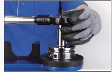
6. 使用扭力扳手以順時針方向平均使力鎖緊螺帽
