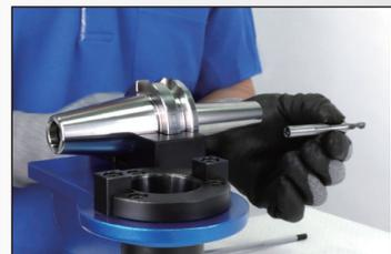
3. 將刀桿置於鎖刀座固定，使用扳手，以逆時針方向轉動後拉螺絲，鬆脫筒夾及刀具
