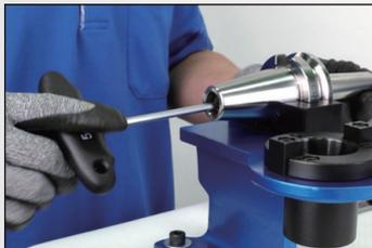
4. 使用扳手，以順時針方向轉動後拉螺絲，鎖緊筒夾及刀具
