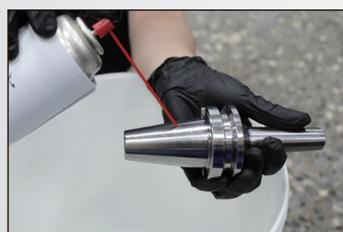
1. 使用防鏽油做防鏽處理，並戴上手套避免手的水氣或髒汗再次接觸
