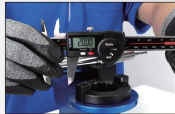
3. 使用游標卡尺測量所需刀具長度
