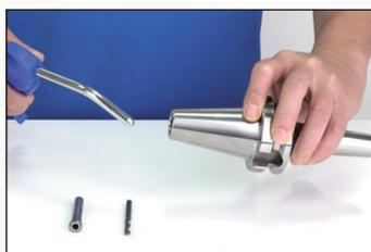
5. 使用風槍清潔刀桿、筒夾的鐵屑以及髒(油)汗，避免凹槽或內孔殘留鐵屑
