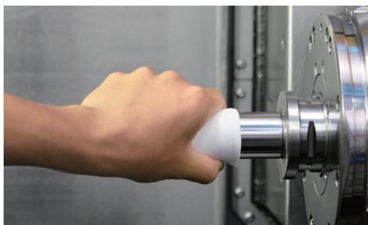
主軸精密標準棒置入主軸後，
